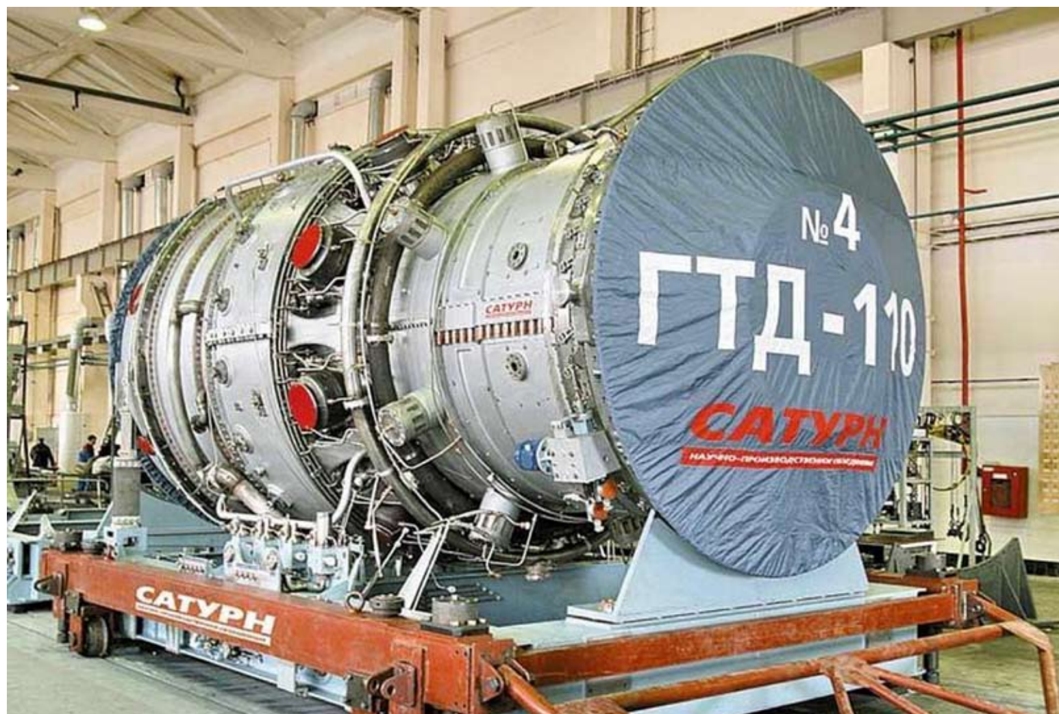
Газовая турбина ГТД-110, изготовленная в Рыбинском научно-производственном объединении «Сатурн».
