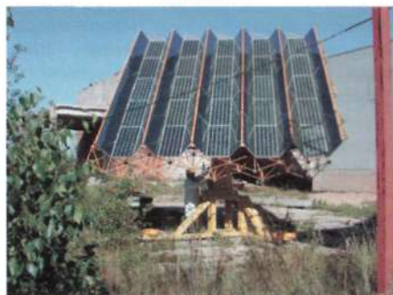
Рис. 5. Автономные солнечные установки ФГУП НПО "Астрофизика" с металлическим концентратором и двигателем Стирлинга (а) и фотоэлектрическая с концентрированием солнечной энергии (б)
