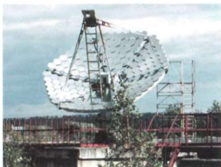
Рис. 5. Автономные солнечные установки ФГУП НПО "Астрофизика" с металлическим концентратором и двигателем Стирлинга (а) и фотоэлектрическая с концентрированием солнечной энергии (б)
